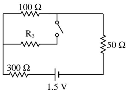
Figura 4: Circuito eléctrico con resistencias, interruptor y batería.
